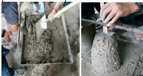
Gambar 1 Pengujian workability pada beton segar
